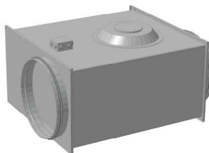
КОРПУС вентилятора из оцинкованной стали обеспечивает надежную защиту от коррозии. По специальному заказу внешняя поверхность корпуса может быть выполнена с нанесением порошкового покрытия. Сервисная крышка необходима для прямого доступа к рабочему колесу и двигателю при монтаже или обслуживании вентилятора. Сервисная крышка предусмотрена для всех типоразмеров C-VENT-PF.
